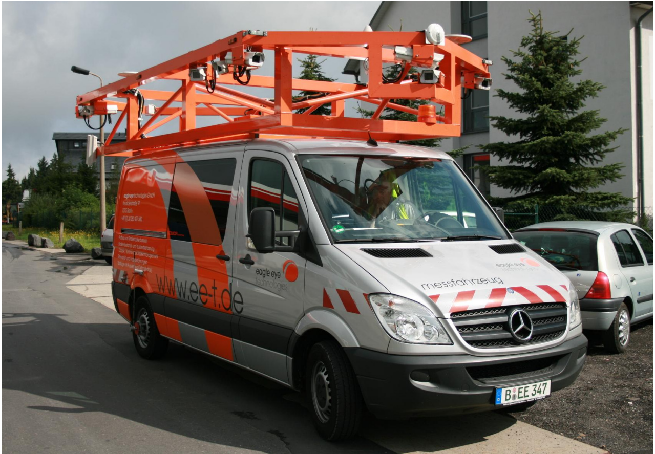
Abb. 3 Mobile Datenerfassung mit dem eagle eye XL
