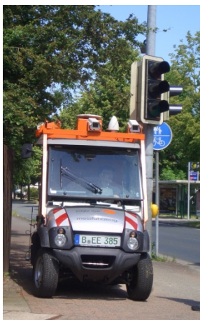
Abb. 5 Schmalspurfahrzeug eagle eye XS
