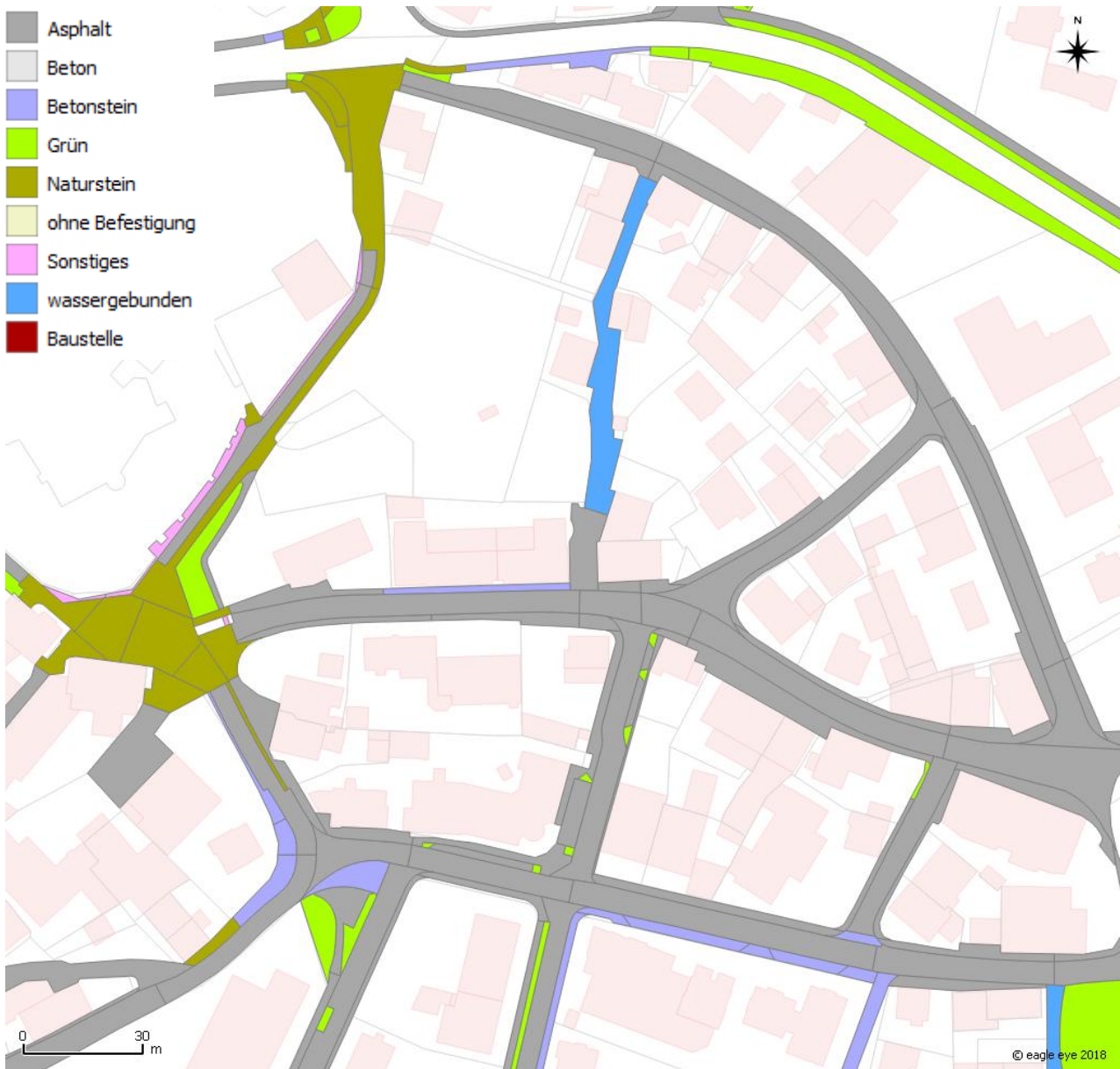
Abb. 9 Beispielhafte Visualisierung der Materialien (Bachstraße im Bildzentrum)
