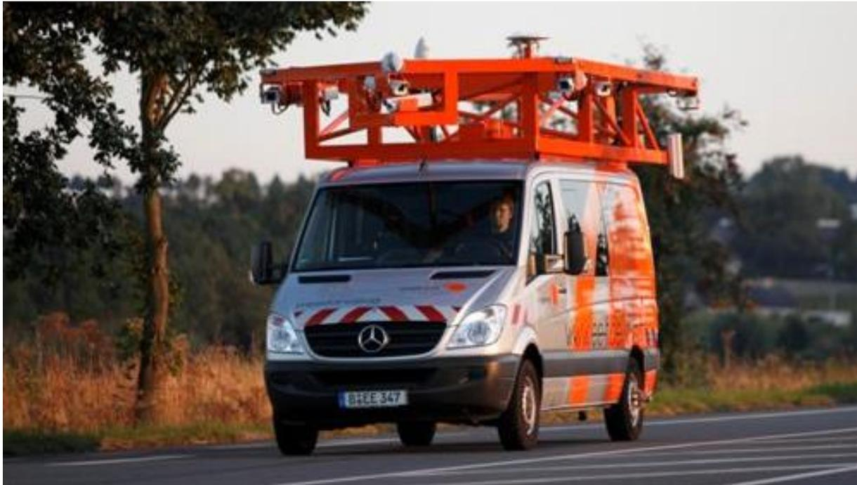
Abb. 4: kinematisches Messfahrzeug eagle eye XL1
