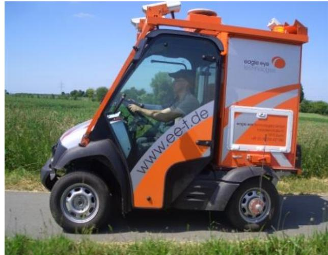
Abb. 5: kinematisches Schmalspurfahrzeug eagle eye XS
