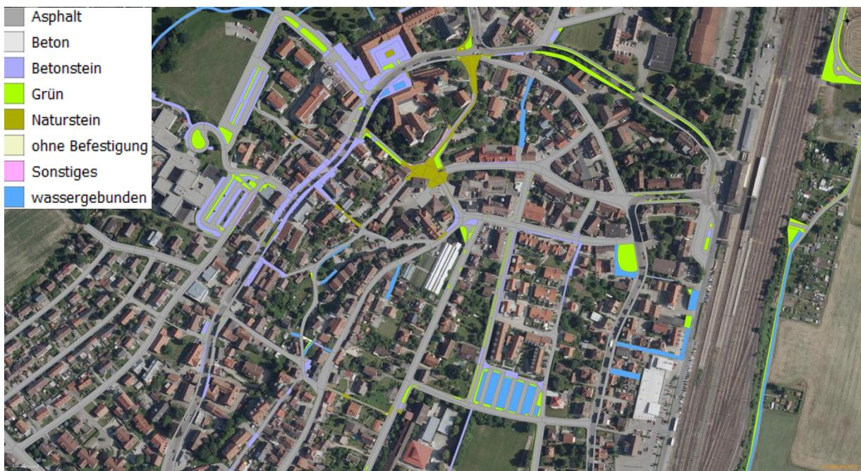
Abb. 10: Beispiel einer thematischen Karte (Einfärbung nach Deckschichtarten)
