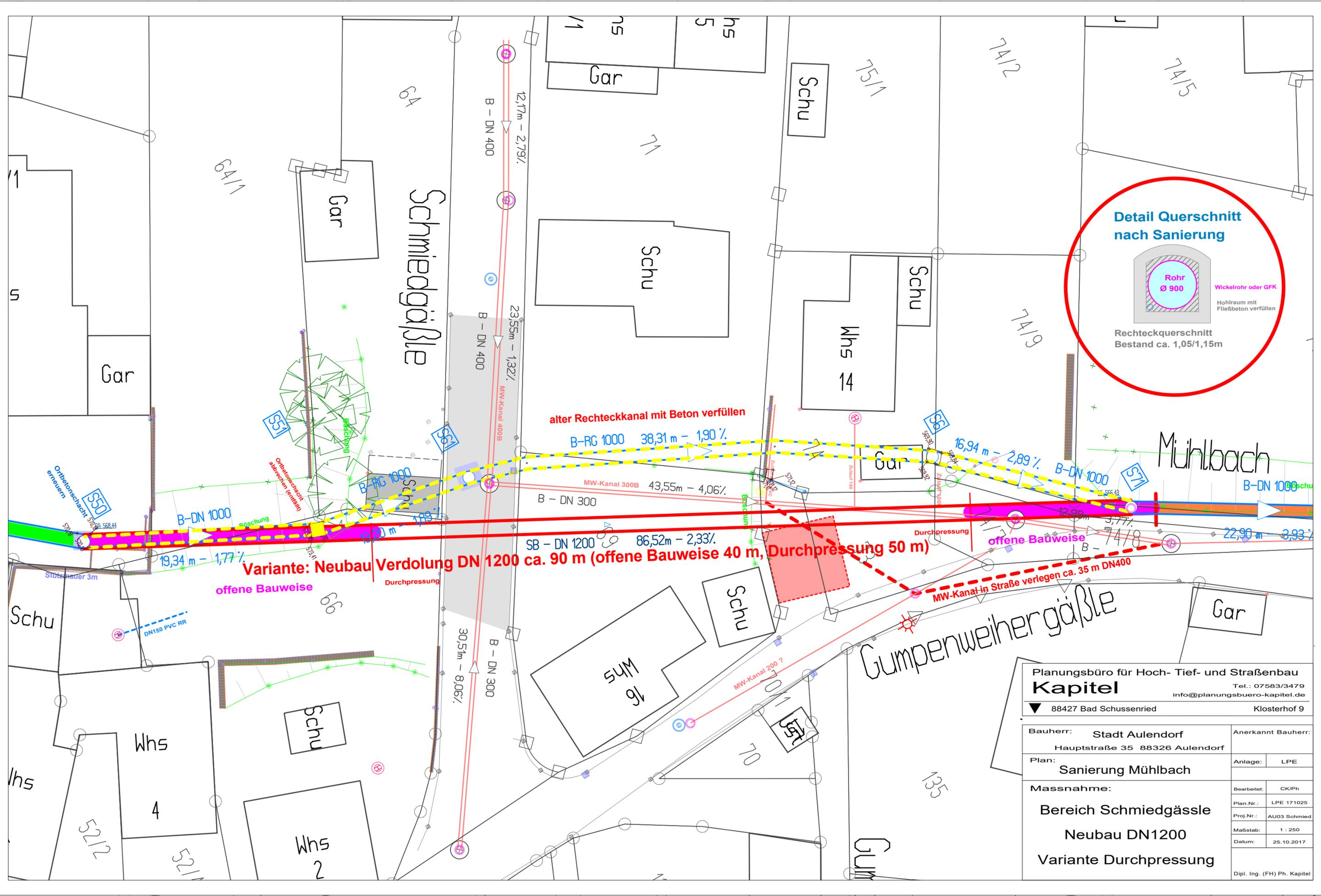
**Variante: Neubau Verdolung DN 1200 ca. 90 m (offene Bauweise 40 m, Durchpressung 50 m)**
