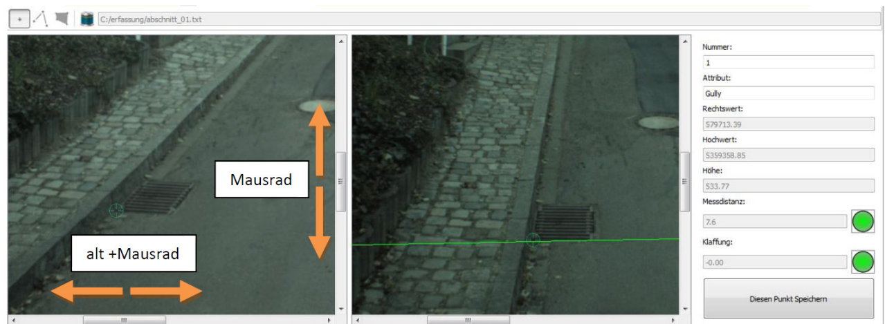
Abb. 14 Stereomessmodus der Funktion Messen im Bild im eagle eye Viewer
