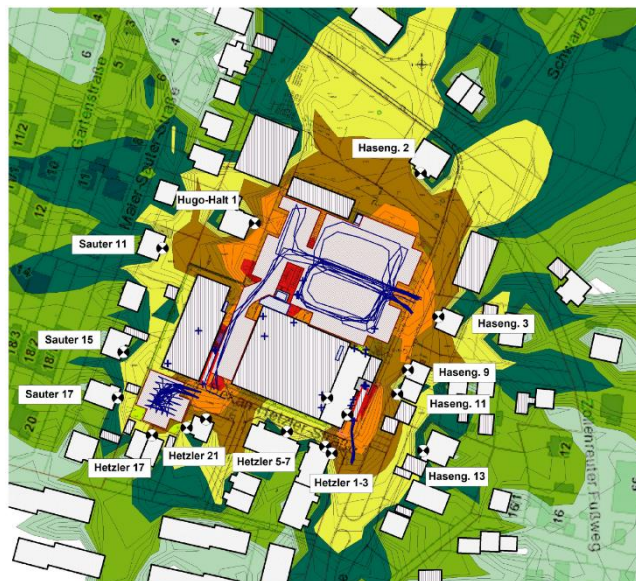
Abb. 10 Lärmrasterkarte Schallimmissionsprognose 17.08.20 Ing. Büro für Bauphysik Dipl. Ing. Ch. Malo
