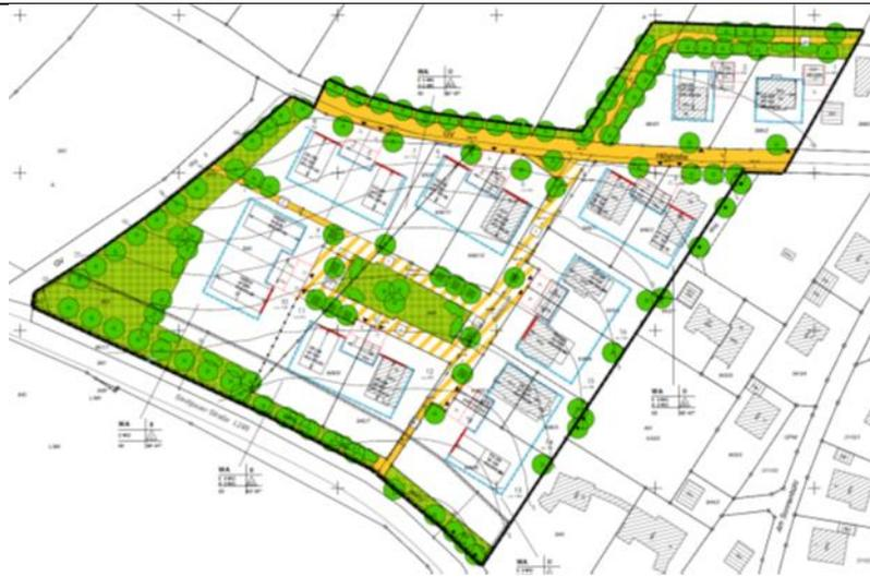
Mit der Änderung des Bebauungsplanes sollte zunächst für die bisher unbebauten Bereiche (Grundstück Flst. Nr. 950) eine Nachverdichtung, vor allem durch Reduzierung der Grundstücksgrößen und die Verkleinerung des zentralen Platzbereiches erreicht werden.
