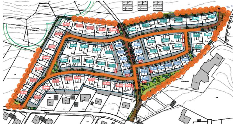
Abb. 14 Erdwärmesonden (Quellenanlage)
