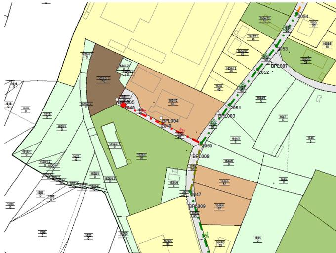
Abbildung 7: Lageplanausschnitt Prognosezustand, T=3a, unsaniert, abgehängte Flächen Heydt/Burger, Zufluss in Haltung 2048-2049 4 l/s, 1,5 l/s aus Prognosefläche 1618
