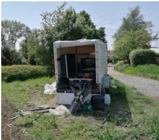
Abbildung 7: Vorbereitung zur Durchführung des TRT am Standort Marienbühlstraße in Aulendorf (© Bild: boden & grundwasser GmbH).
