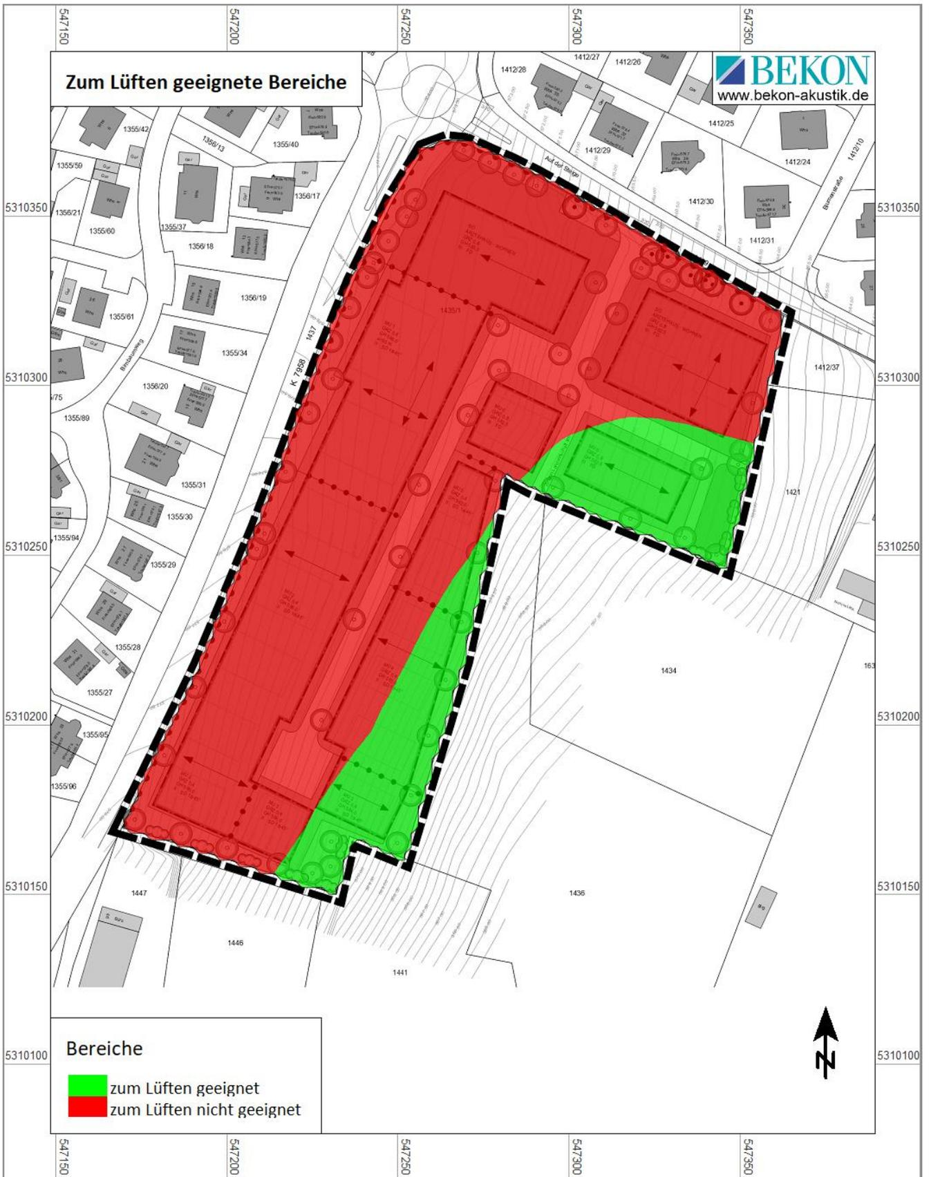
Abbildung 8: Zum Lüften geeignete Bereiche, Karte o.M.
