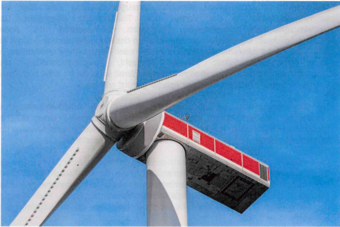
Abbildung 3: ENERCON E-160 EP5 E3 Gondel
